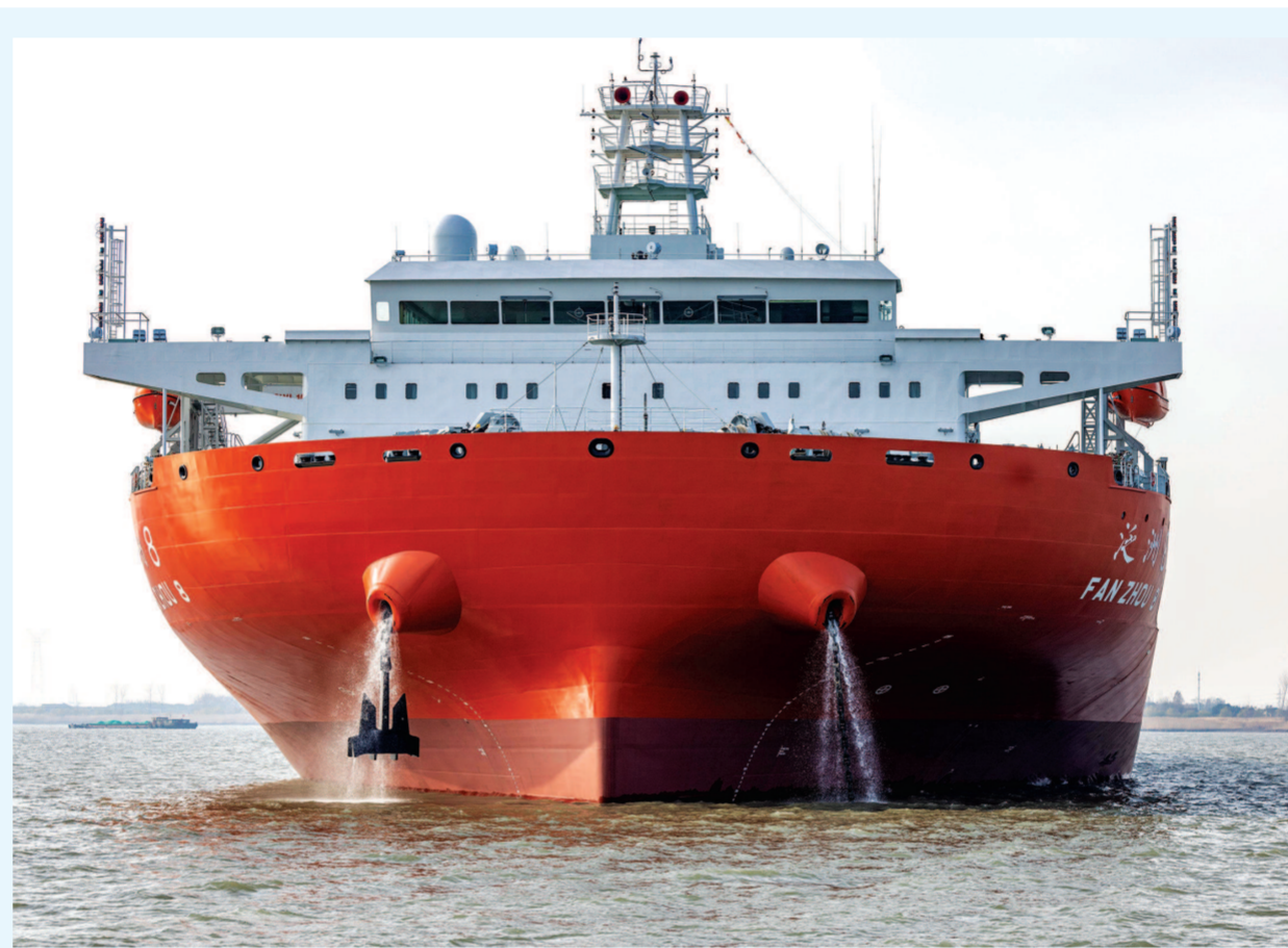
12月22日，“泛洲8”轮从泰州锚地起锚。在海事部门全程协调维护下，大型自航甲板船“泛洲8”轮从上海以东水域进行为期5天的各种专业航海测试后回港。“泛洲8”轮总长256米，型宽51米，型深13米，最大
