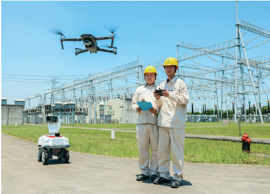
国网上海超高压公司500千伏亭卫站运维人员应用无人机和智能机器人开展设备巡视。(本版图片均国网上海电力供图)
