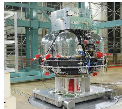
“微笑卫星”正样磁测试试验。
