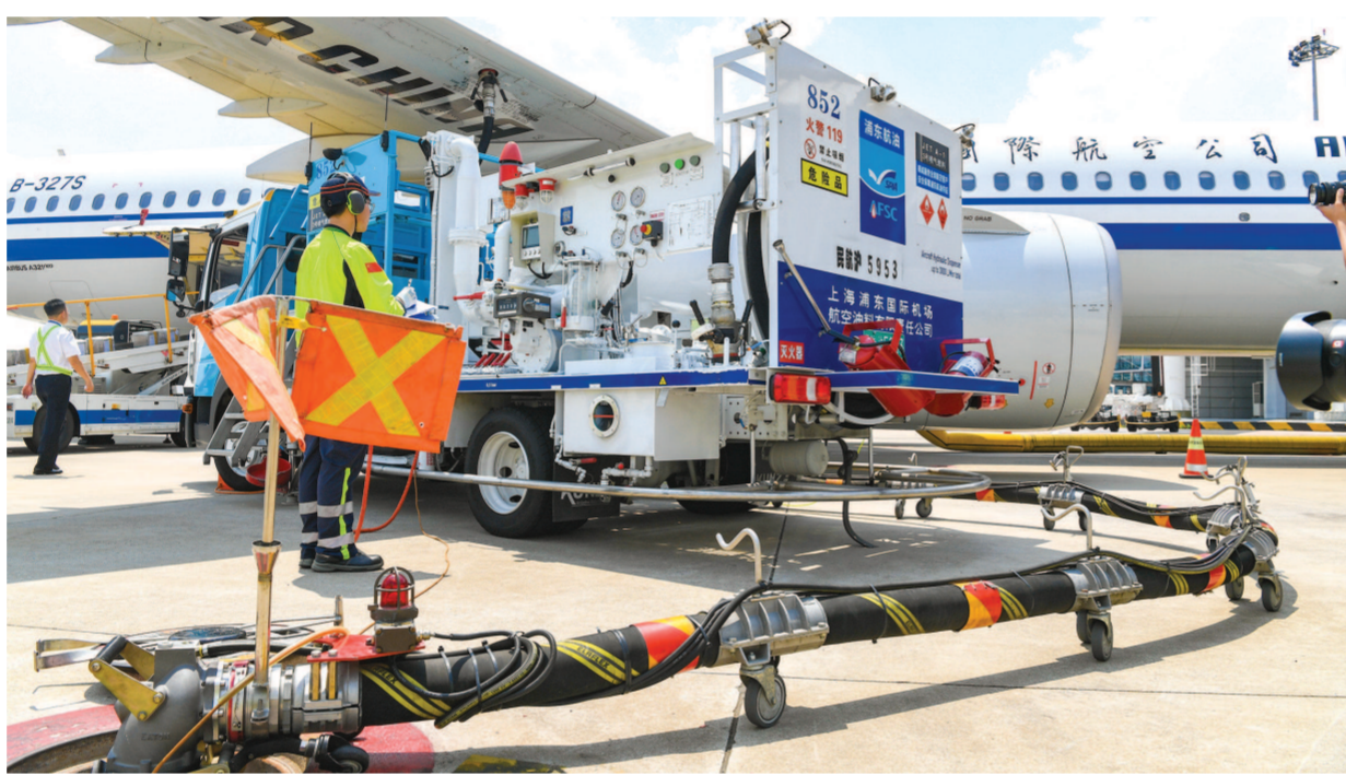
航班进港后，飞机加油员需要在灼热的飞机发动机旁为飞机进行加油作业。本报记者 张伊辰摄
