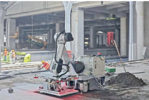
智能石材铺贴机器人在施工现场作业。(受访者供图)
