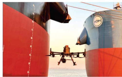
外高桥造船利用无人机结合AR技术开展船舶远程检修。(受访者供图)
