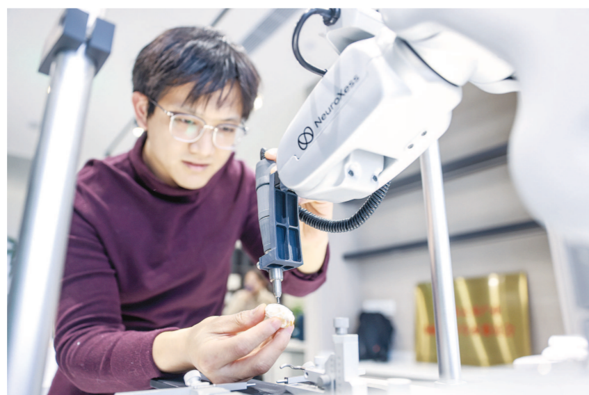
脑虎科技自主研发的智能手术机器人可以基于标准小鼠脑定位图谱3D脑区模型,最优化计算手术路径,实现“所想即所得”的定制化。
