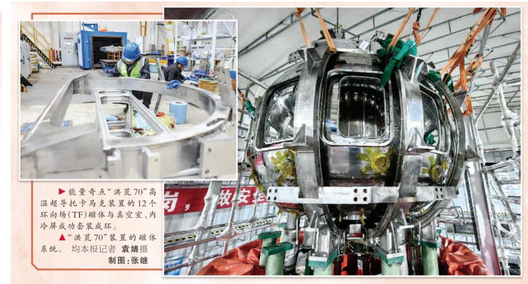
▲ 能量奇点“洪荒70”高温超导托卡马克装置的12个环向场(TF)磁体与真空室、内冷屏成功套装成环。
