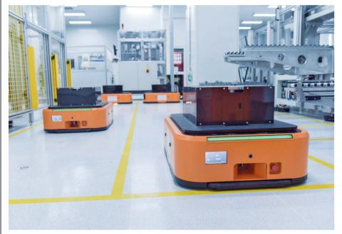
数字化如何让汽车零部件制造工厂变 得更聪明高效? 走进联合汽车电子有限公司 机器人智能完成,无人驾驶AGV小车穿行其 中,搬运、上下料,与现场工作人员配合默契。
