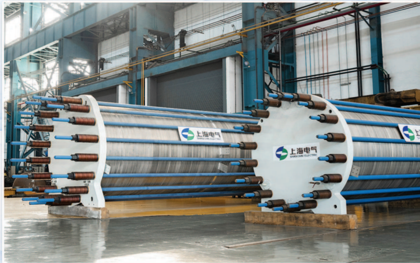
在首届碳博会上,上海电气发布了旗下氢器时代公司研制的新一代碱性电解水制氢设备。(均受访者供图) 制图:冯晓瑜
