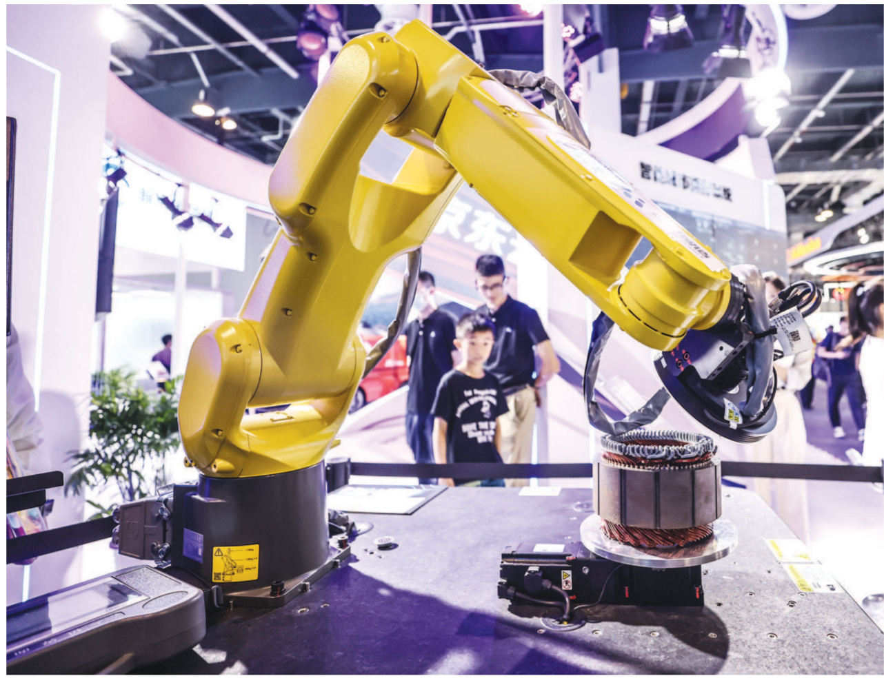
工小匠AI数字质检员可利用AI技术进行产品外观缺陷检测。 本报记者 袁婧摄
