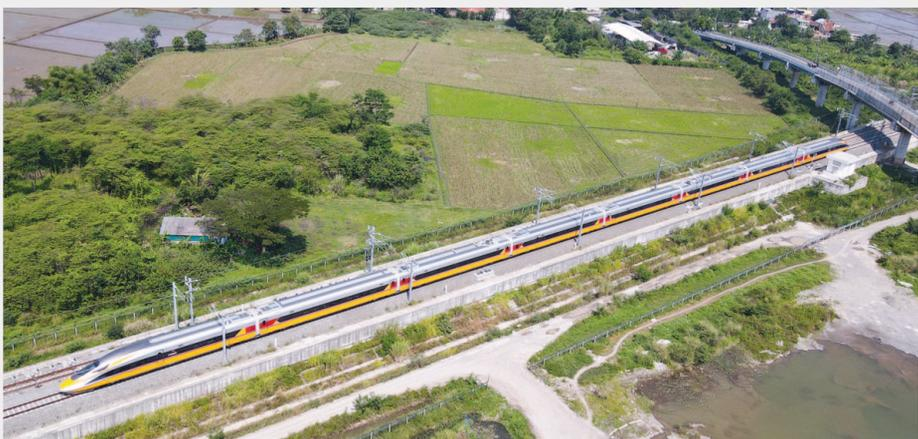
22日，雅万高铁联调联试综合检测列车的运行时速首次达到350公里，标志着雅万高铁已达到设计速度标准。图为综合检测列车行驶在雅万高铁上。 新华社发
