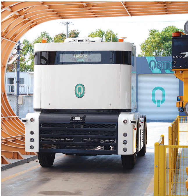
在上海一处无人驾驶研发和测试基地,无人集卡在智能换电。本报记者 徐晶卉摄
