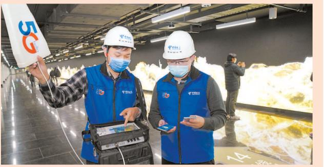
上海电信以创纪录的建设速度，完成了地铁14号线的网络覆盖建设任务，保证了5G信号满格。图为电信技术人员在14号线陆家嘴站测试网络信号。
