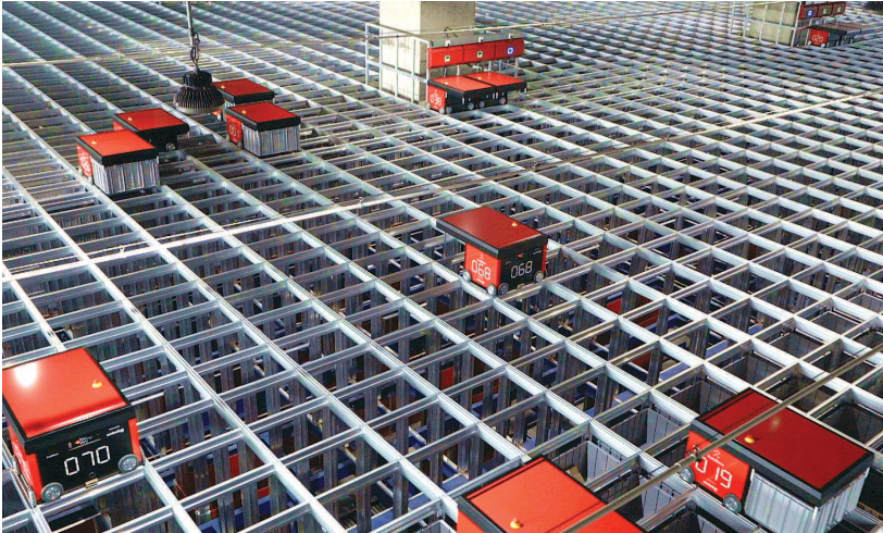
在近铁半导体全球分拨中心，近100台红色自动小车可以在11万个料箱中自动抓取货物。
