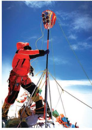
2020珠峰高程测量登山队成功登顶后，在峰顶竖立觇标，安装GNSS天线，开展各项峰顶测量工作。新华社发
