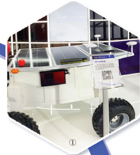
①②:在上海·机器人矩阵现场展出的AI采摘机器人,结合六自由度机械手采用3D视觉系统,可进行仿生鲜果类采摘作业。
