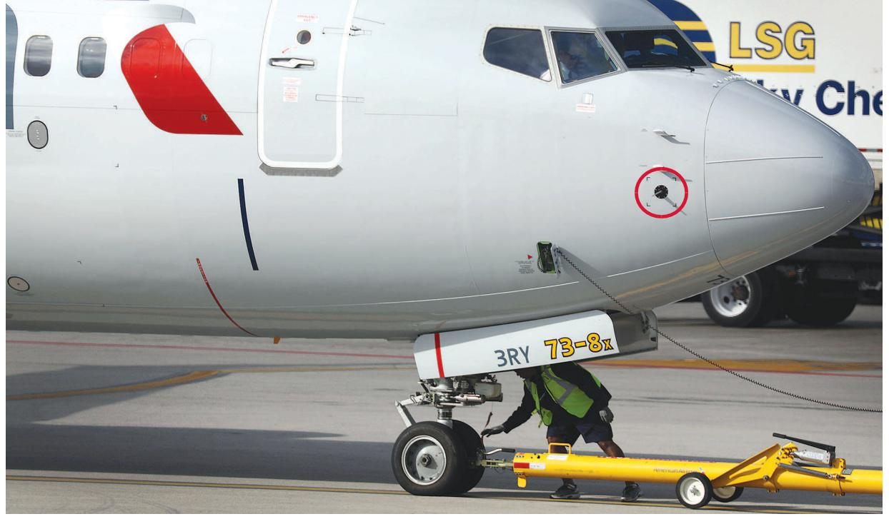
波音737 MAX 8的机头部分,图中红色圆圈部分为感知飞机姿态的传感器。
