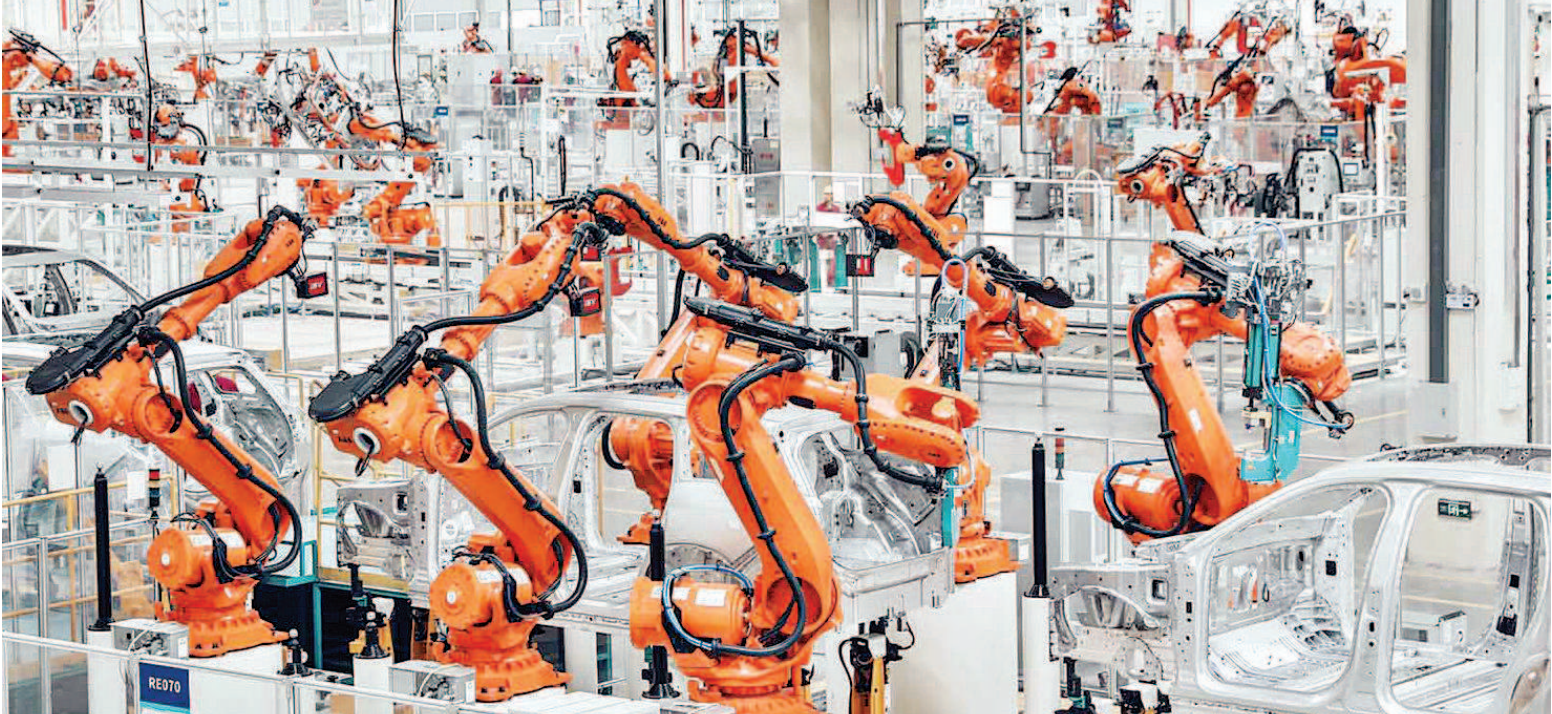
蔚来汽车合肥工厂内景，这里拥有全世界自动化程度最高的全铝车身制造工厂。（资料照片）
