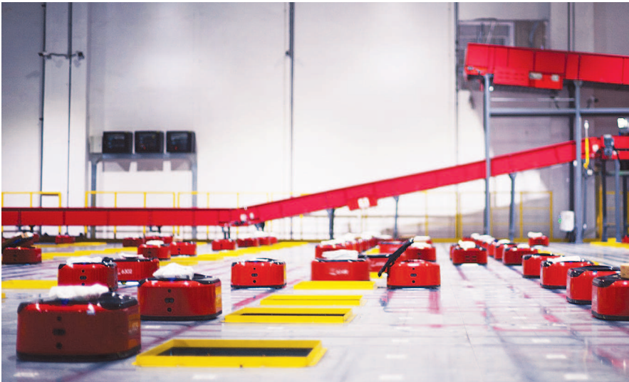
全流程无人仓库内,自动分拣运输机“背”着商品穿梭。(资料照片)
