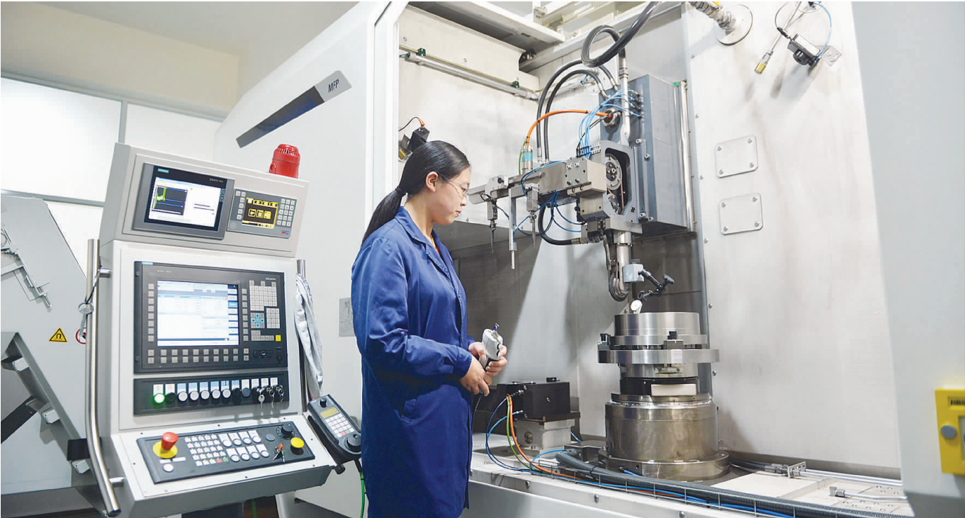
高精度减速机的制造是自主工业机器人的瓶颈之一。图为南通振康的技术人员正在测试数控机床。
