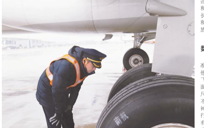
起飞前，南航机长王锐在停机坪检查飞机起落架。本报通讯员 方方圆摄
