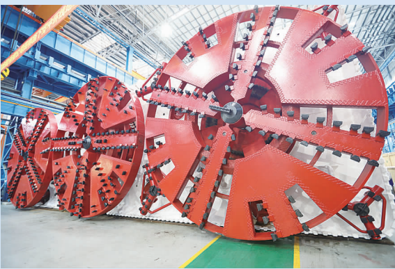
图为上海城建市政工程(集团)有限公司设计研发的世界最大断面的土压平衡式箱涵掘进机
