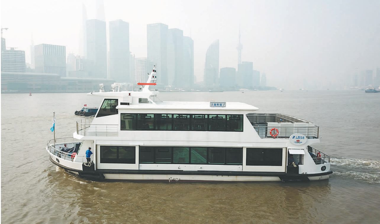
昨天,上海轮渡1号、2号客渡船在北外滩其泰线投入营运。图为新投用的客渡船,新船在船型上更加现代,容量为300客位,分为上下两层。(市轮渡公司供图)
