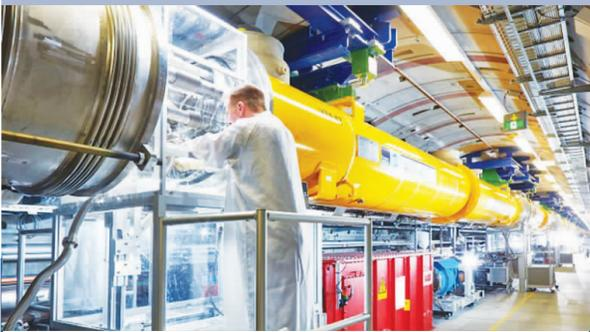
去年 9 月投入使用的欧洲 XFEL 是目前发射速率最快的硬 X 射线自由电子激光器，1 秒能为分子拍 3000 张高质量 X 光片。
