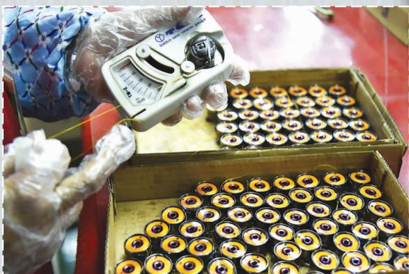
▲底线张力测试，确保零部件配合顺畅。
