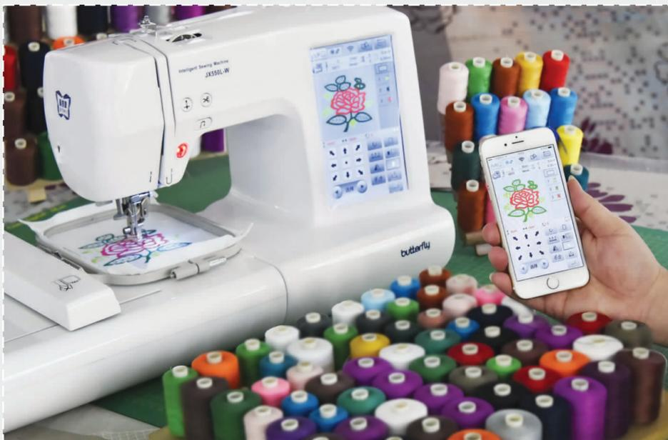
▲互联网技术的有机融入，使传统缝制设备成功转型成为物联网大家族中的一员。缝纫机加装WiFi模块系统后，用户可通过App应用软件进行无线连接操控，缝纫、刺绣变得简便有趣。
