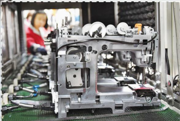
▲每台缝纫机机壳都要经过研磨，以提高零部件的耐磨性、耐腐蚀性和抗疲劳度，延长使用寿命。
