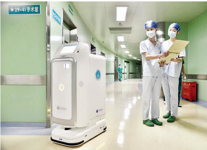
机器人“大白”能根据被植入“大脑”的手术室地形图规划路线，自动定位、导航、行走、避障，保证又快又好地运送手术耗材。图为“大白”在把耗材送到指定手术室的路线上自动转弯前行。(刘坤维供图)
