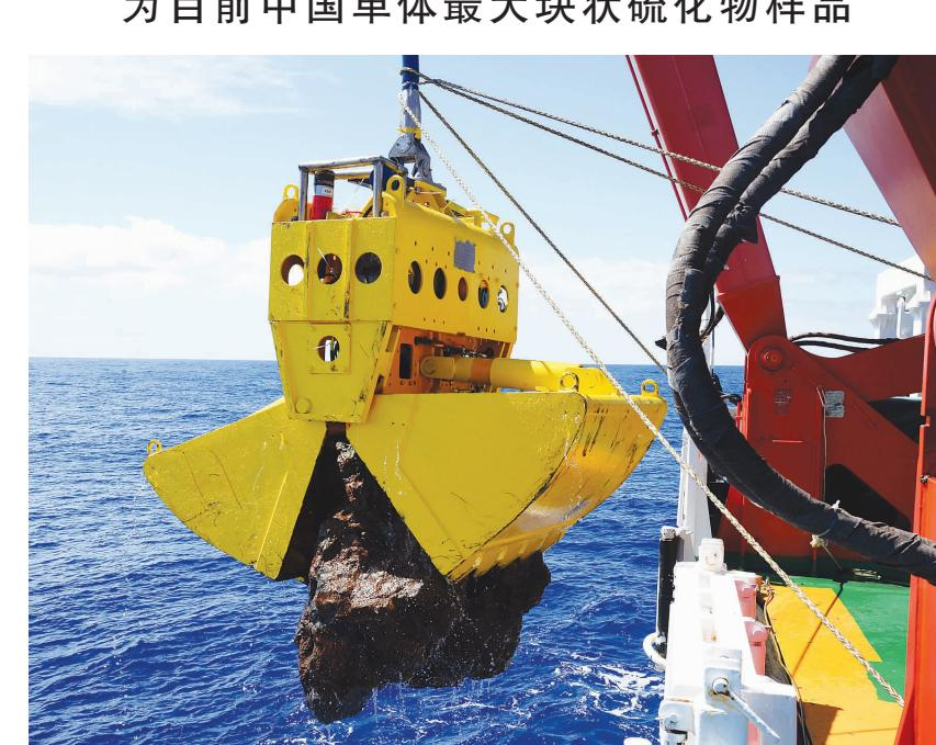
正在执行中国首次环球海洋综合科考暨中国大洋科考46航次的“向阳红01”船，于西一区时间11月30日在南大西洋采集到一块单体重约3吨的块状硫化物样品。这是目前中国采集到的单体最大块状硫化物样品。图为抓获了块状硫化物的电视抓斗正被回收至母船（当地时间11月30日摄）。
