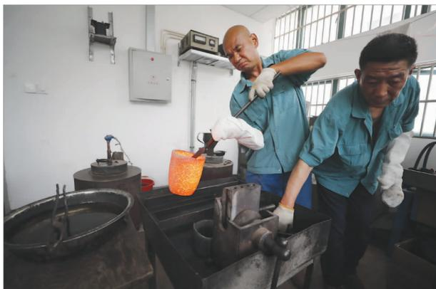
▲配好的黄金在熔金炉里经5小时“闭关修炼”已化为“金水”。
