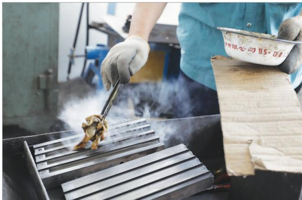
▲师傅用煤油先将烧热的模具擦拭一遍，发出“嚓嚓”的响声。
