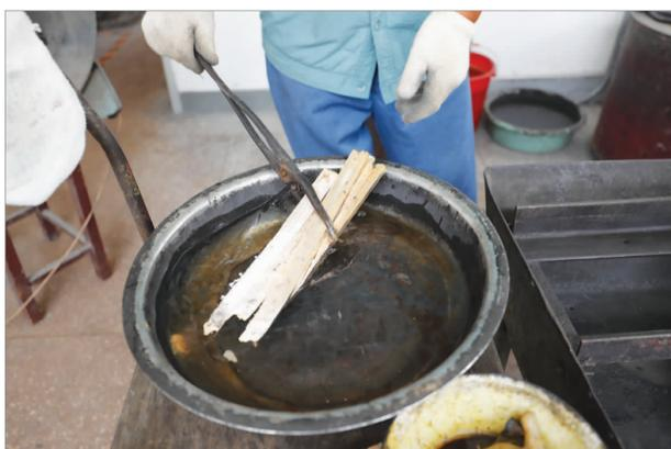
▲脱模的“金条”经冷却处理后进入关键的锉金、轧金程序。
