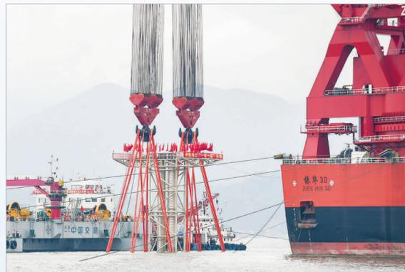
▲2017年5月2日,晨曦中的“振华30”起重船静卧在伶仃洋海域,等待起吊海底隧道的最后接头。港珠澳大桥岛隧工程海底隧道由33节沉管和1个最终接头连接而成,承担约6000吨重最终接头的“振华30”起重船是中国交建下属上海振华重工设计建造并自营的世界最大起重船。
