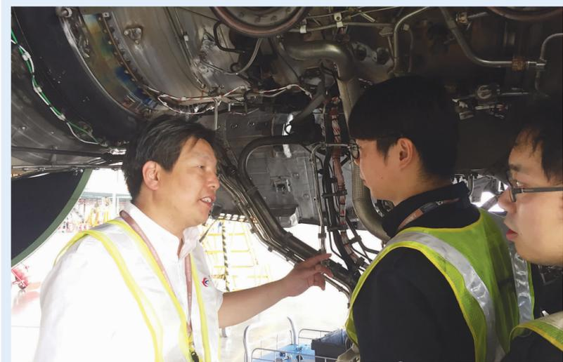
吴刚(左)在维修基地机库和同事一起查看飞机发动机机外管线。本报记者李静摄
