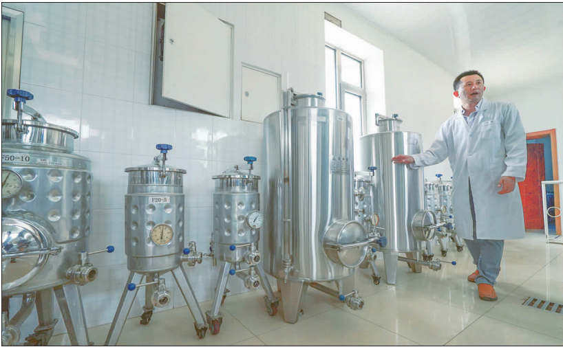
▲大小不一的不锈钢发酵罐,用于酿酒葡萄新品种培育过程中的单株酿造试验。
