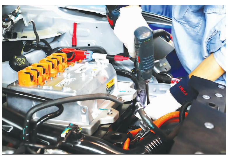
▲技术人员正在安装新能源电池。
