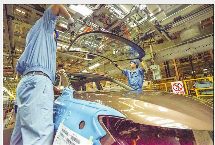
▲借用机械臂安装前挡风玻璃。
