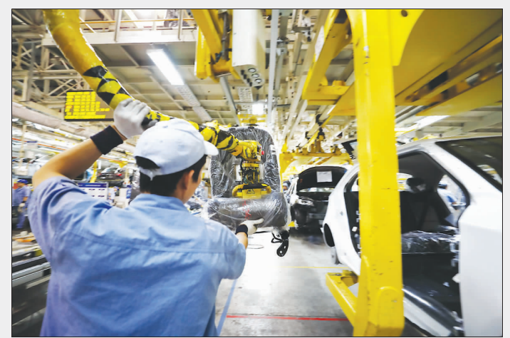
▲巨大的机械手臂将座椅“抓”入车架内。
