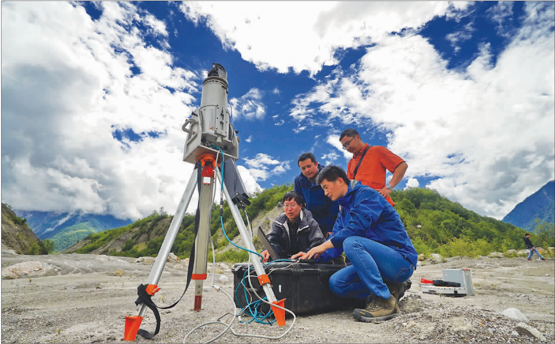
▲位于西藏自治区东南部的波密县易贡乡,2000年曾发生特大滑坡碎屑流、堰塞湖、洪水溃决、泥石流灾害链。图为科研人员用3D激光扫描仪对这一区域进行扫描,获取灾害发生后的地貌形态数据,并结合滑坡预测模型,分析灾害再度发生的可能性及其危害范围,从而为川藏铁路选线中的隧道和桥梁进出口提出相对应的标高建议。
