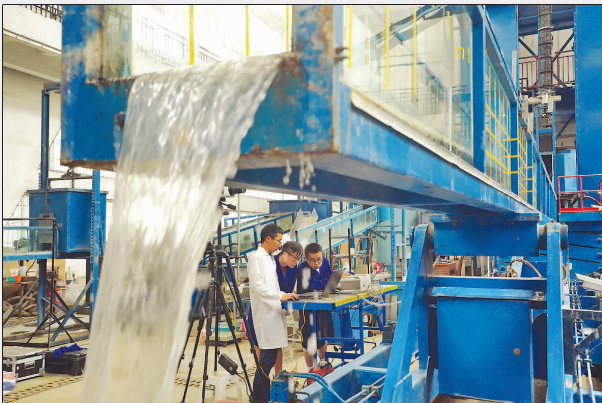
▲室内水槽实验用以获取溃决过程的流量。
