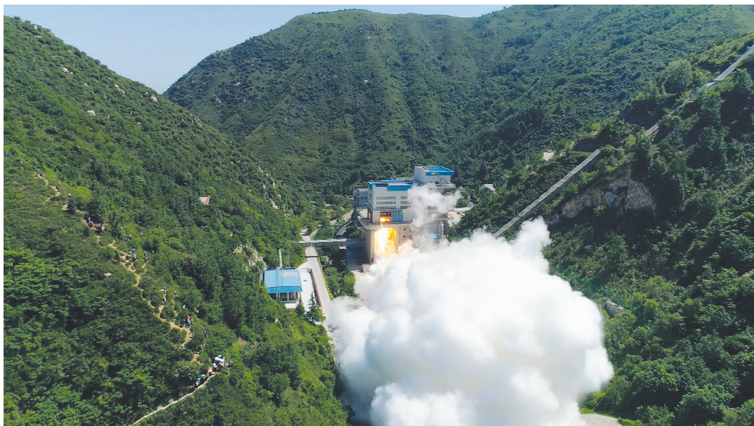
图为在中国航天科技集团六院新一代火箭发动机试验区，901号试车台在为我国首台泵后摆火箭发动机进行测试。
