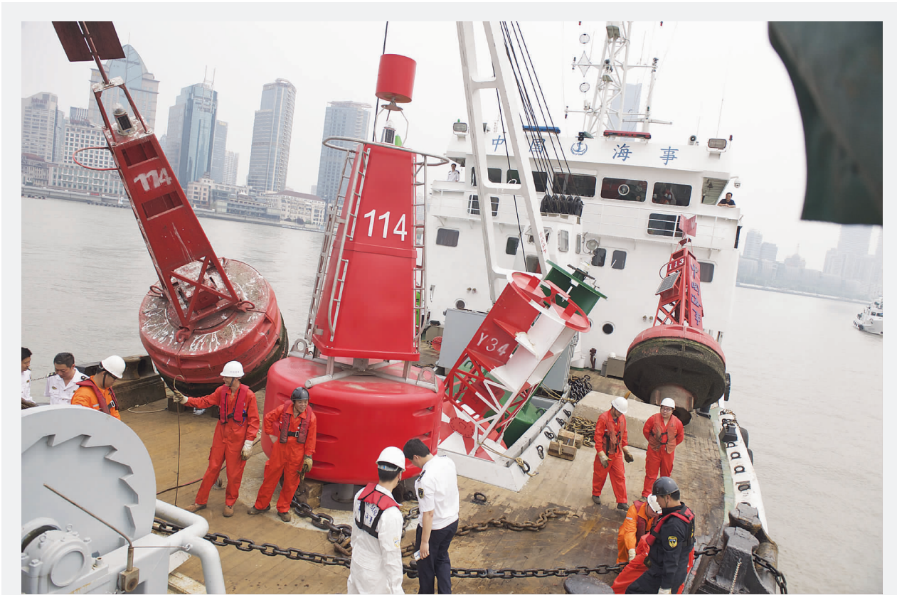
昨天,上海航标处“海巡167”轮前往陆家嘴、外滩水域抛设三座新型浮标,第一期黄浦江核心水域浮标改造工程完成。据介绍,新型浮标采用先进生产技术和工艺,具有色彩鲜艳、结构坚固、操作轻便、使用周期长等特点。 本报记者 何易 通讯员 虎皓严摄影报道
