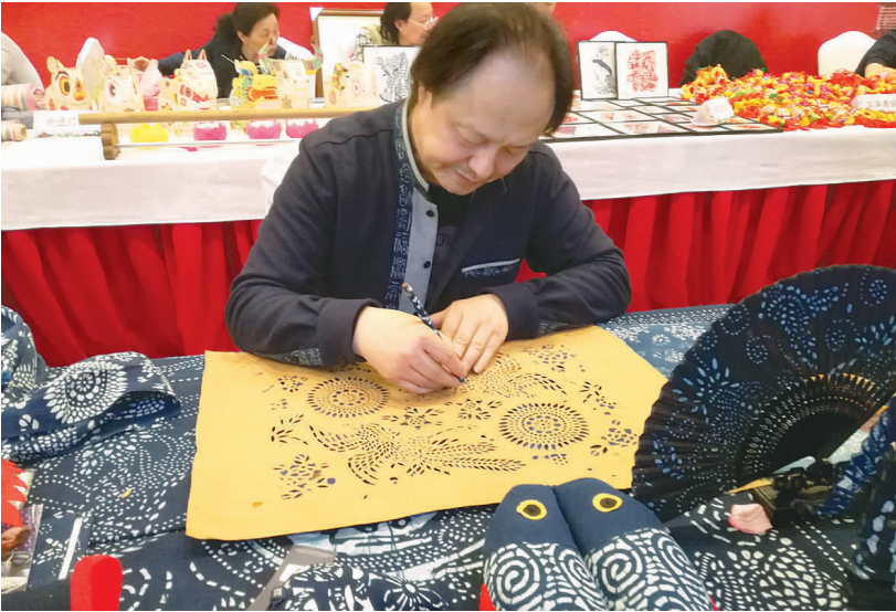
吴元新在进行蓝印花布的基础工序——刻板。
