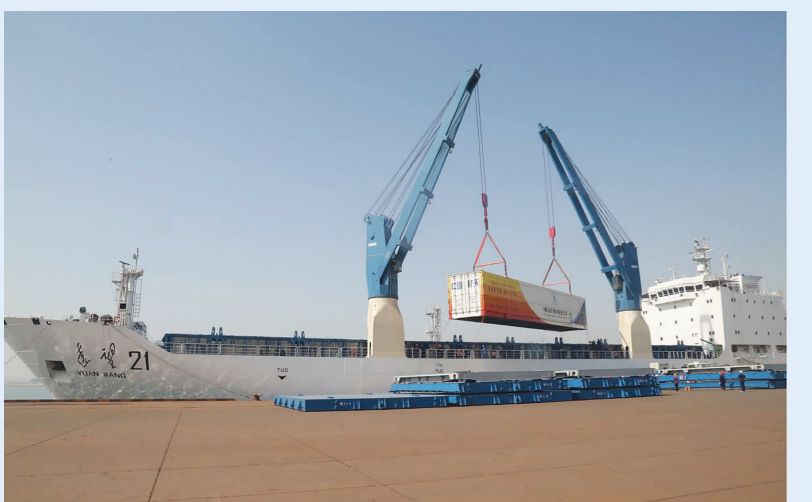
图为船用吊车联吊集装箱。
