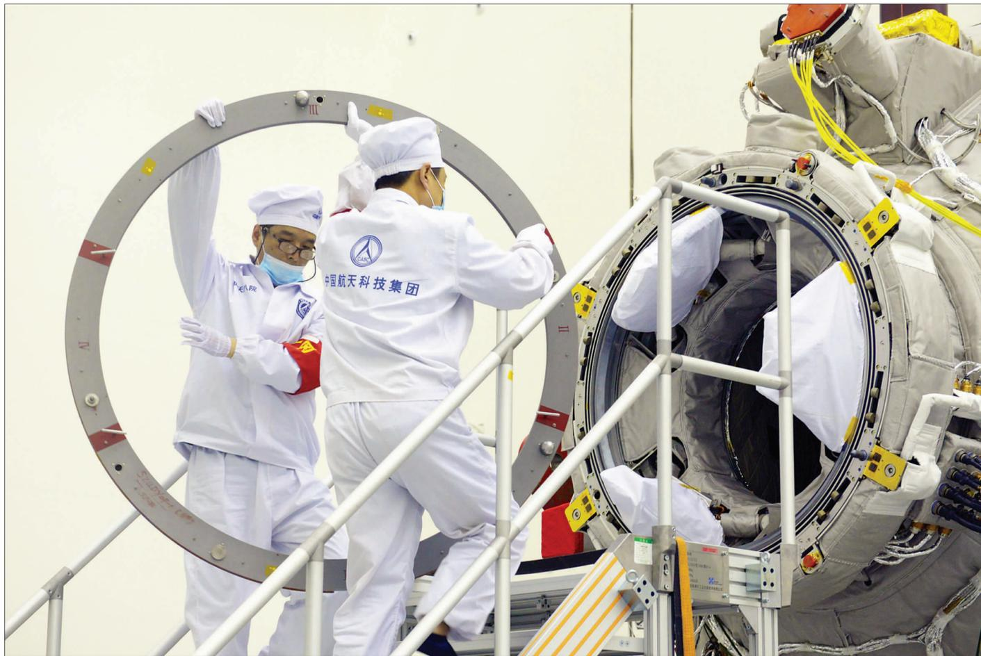
▲货船水平测试结束后总装操作人员安装对接机构对接面保护罩。
