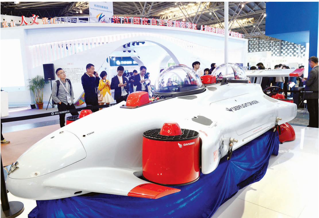
水下飞行潜艇可实现海中飞行、升降以及直升悬停运动。
