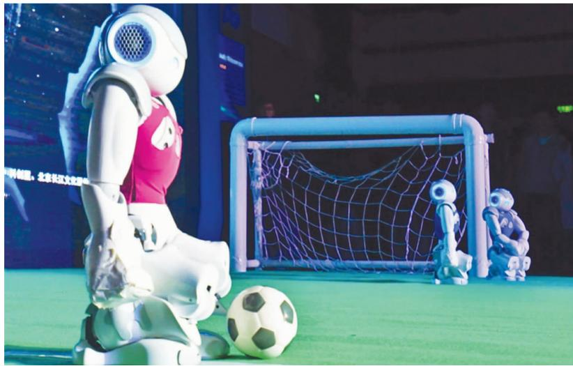
来自同济大学的足球机器人，可在自然光线下完成比赛，还可利用声音进行相互之间的通讯，更可与人类球员几乎一样在人工草坪上踢球，能够在柔性地面上行进。图为正在表演中的足球机器人。本报记者 谢震霖摄
