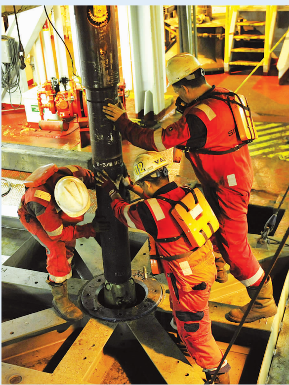
右图:为了给第二个钻孔安装一个“保护套管”,船上将套管装置系统和水下摄像机一起放到了海里,“现场直播”在海底的安装情况。图为“决心”号钻探工人准备“钻孔保护套管”装置(2月23日摄)。
