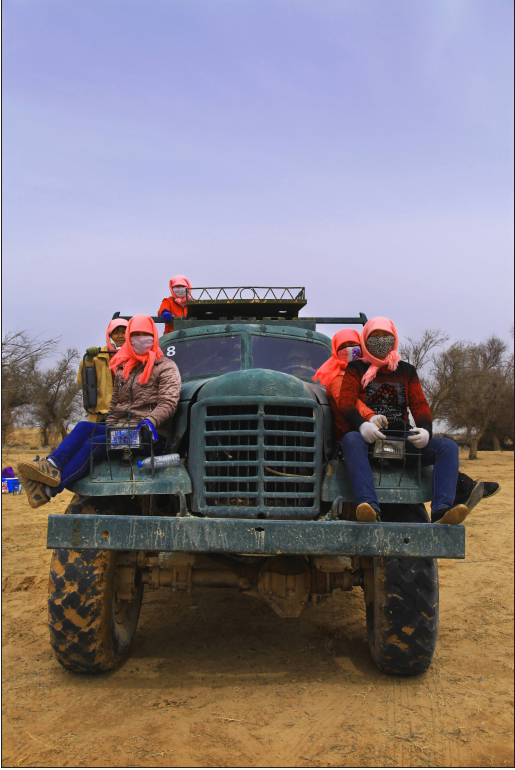
▲由老式解放牌卡车改装的水车。
