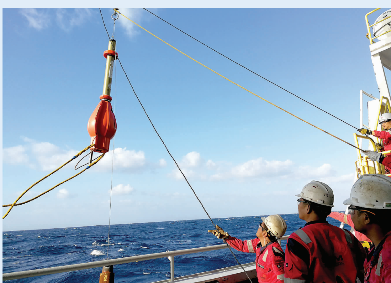
“决心”号上的钻探工人将一个声呐信号装置投入海底。该装置主要用于船舶定位。 新华社记者 张建松摄
