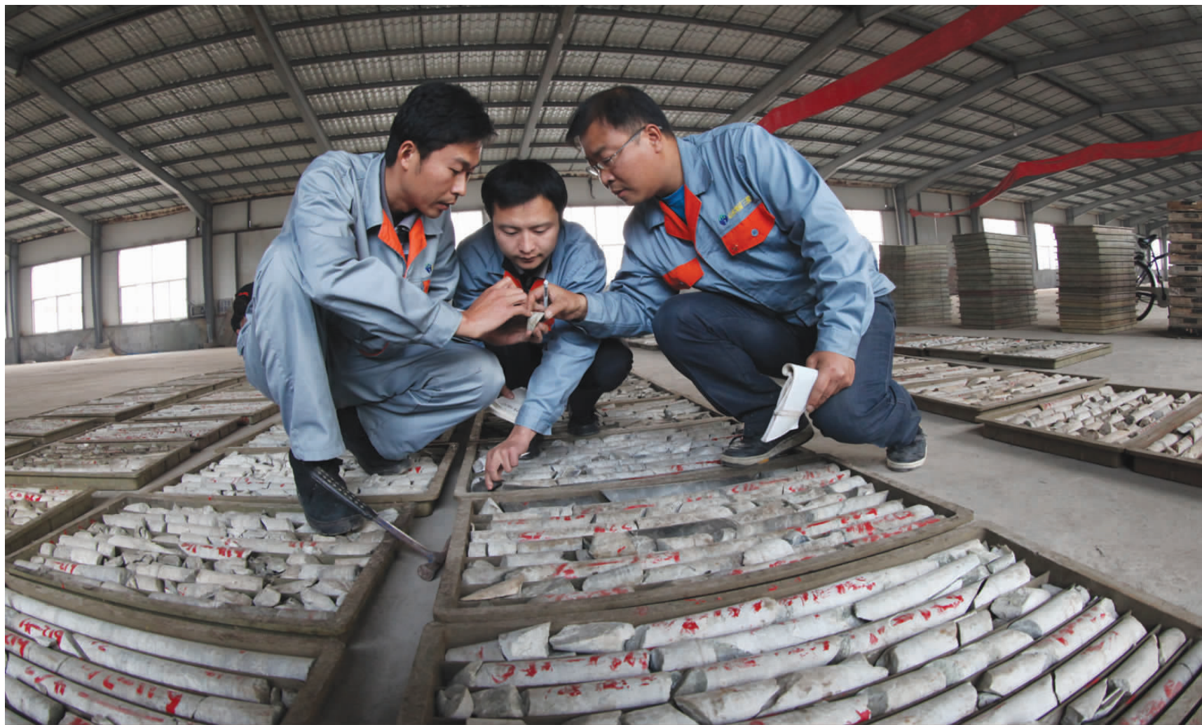
山东省第三地质矿产勘查院勘探技术人员正在分析含矿岩芯。
