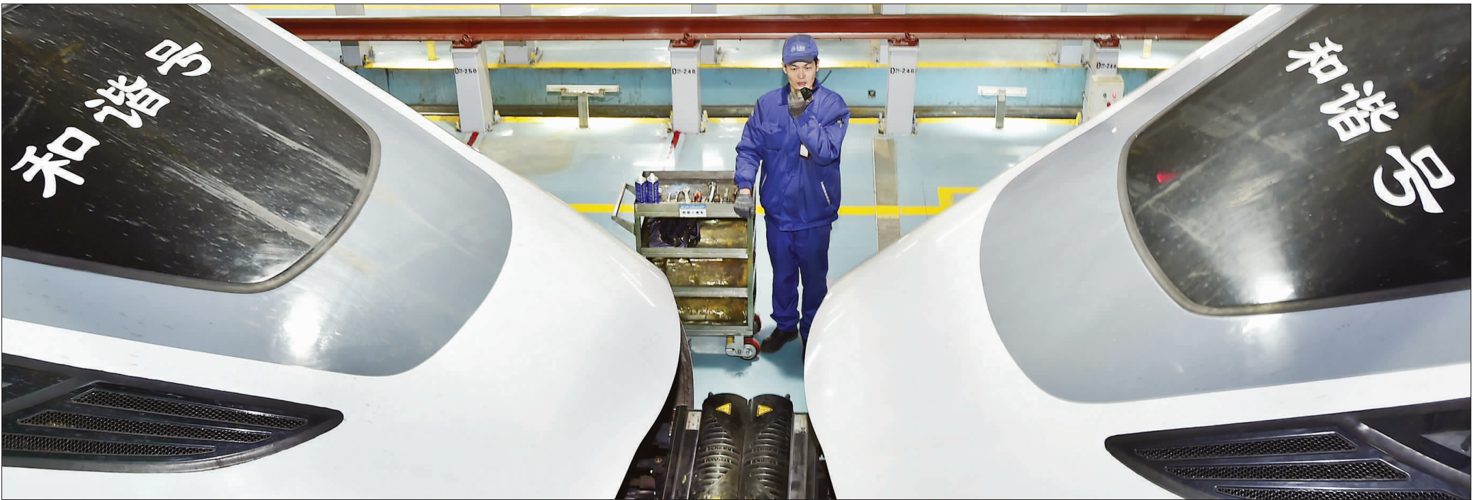
▲动车组机械师在列车重连端检查车钩状态。
