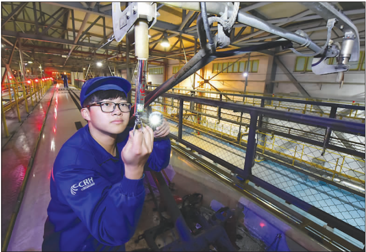
▲动车组机械师任重远在车顶测量受电弓拉力。
