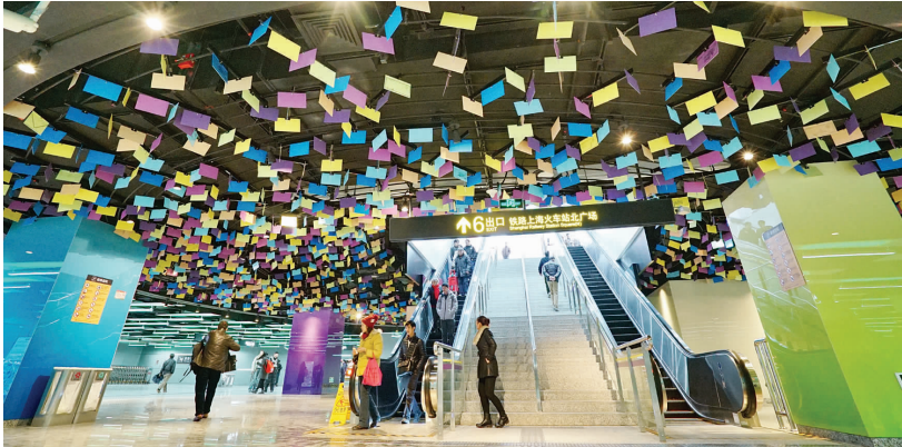
西站厅内的“七彩云”顶棚由七色铝挂片组成，形似纷飞的信封与明信片。
