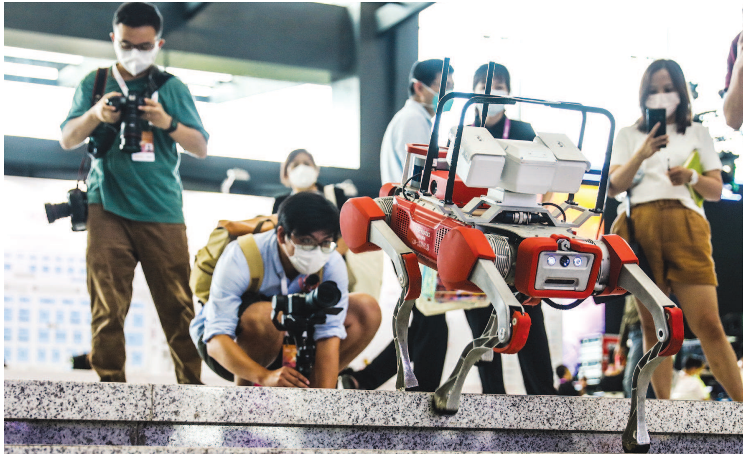
云深处科技的绝影X20消防侦察四足机器人正在大会现场展示避障和爬楼梯的性能,自重50公斤的绝影X20可实现负载85公斤稳定行走。 本报记者 袁婧摄
