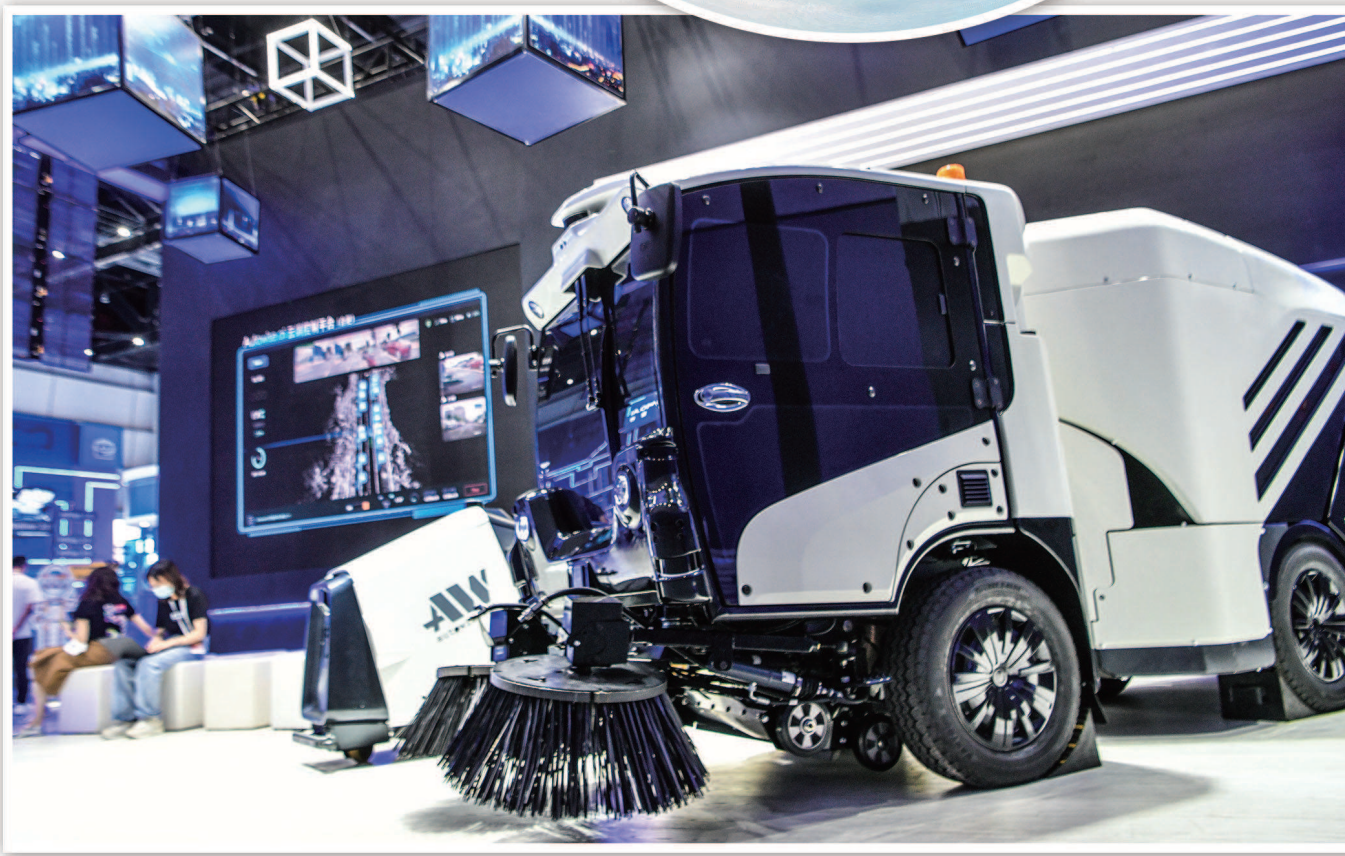
展会现场的智能环卫清扫车,拥有自动唤醒、自主泊车 and 自动倾倒垃圾等功能。
