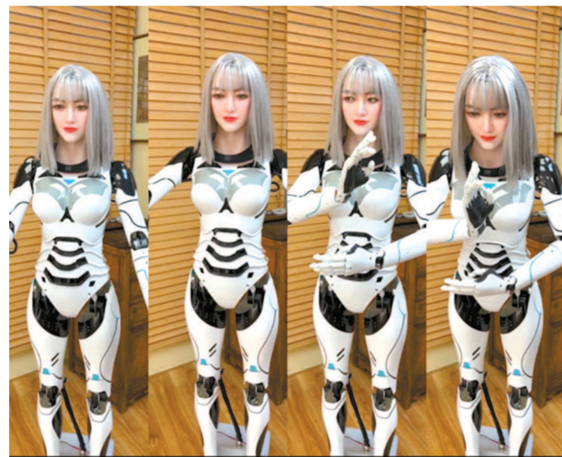
清华大学沈阳教授团队研制的0.4版高仿机器人“清心”，联合虚拟人参与了元宇宙2.0版的内测展示，她可智能交互、声源定位、人脸识别、运动随性，可模仿人脸大多数动作，肌电比达32%以上，让人心悦目。
